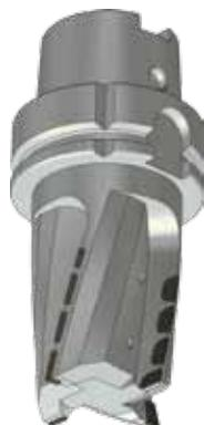
Costruite con corpo in acciaio ad elevata resistenza meccanica • **Con attacco HSK 63-A integrato** • Taglienti in PCD posizionati a spirale • Indicate per elevate asportazioni • Adatte per lavorazioni di sgrossatura di pezzi integrali e per lo svuotamento di tasche chiuse.
