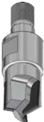
Costruite con corpo in acciaio ad elevata resistenza meccanica • Taglienti in PCD • Diametri da 10 a 25 mm o su disegno cliente • Diverse lunghezze di taglio • Su richiesta realizzate con adduzione interna • Utilizzate con vari sistemi modulari intercambiabili • Adatte per lavorazioni di sgrossatura e fresatura di alluminio e materiali compositi.
