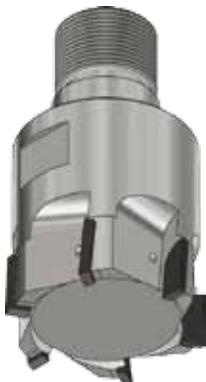
Costruite con corpo in acciaio ad elevata resistenza meccanica • Taglienti in PCD • Diametri da 10 a 32 mm o su disegno cliente • Elevato numero di taglienti per un buon grado di finitura • Diverse lunghezze di taglio • Utilizzate con vari sistemi modulari intercambiabili • Adatte per lavorazioni di sgrossatura e fresatura di alluminio e materiali compositi.
